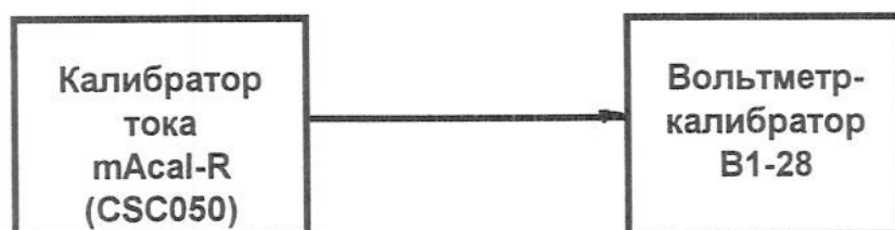
Рис. 7.3 Схема соединений при проверке основной погрешности калибратора в режиме воспроизведения силы постоянного тока
