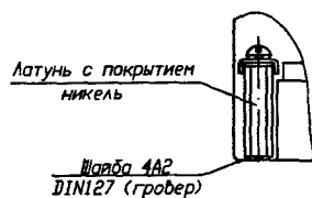
Рисунок 1. 4 (окончание) - Чертеж средств взрывозащиты исполнения ППТС/Exd, с головкой типа "Г101У"
