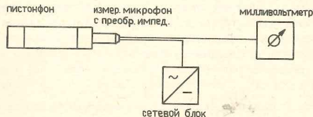
Рис. 3. Измерительная схема для определения коэффициента преобразования измерительного микрофона.
