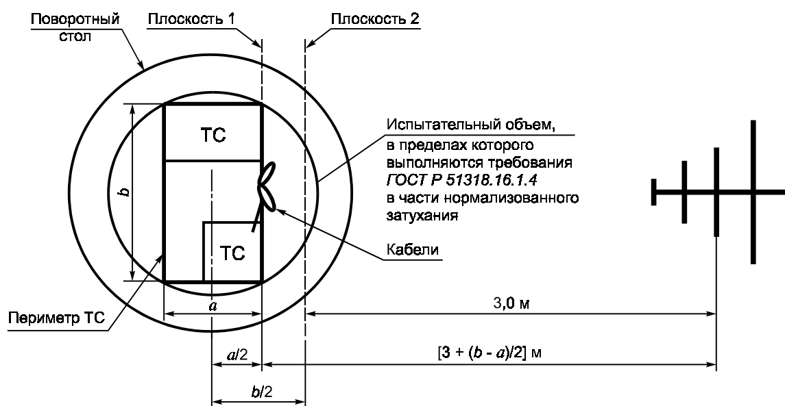
Рисунок 12 — Испытательная установка для напольных ТС, вид сверху
