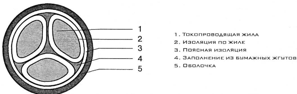
Рисунок 2.2.1-1. Конструкция кабеля марки ААГ с секторными жилами.
