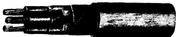
Рис. 5.3. Кабель силовой трехжильный с резиновой изоляцией в свинцовой оболочке на напряжение 660 В без защитного покрова марки СРГ
