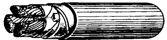
Рис. 3.5. Силевой кабель в металлической оболочке марки СГ
