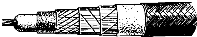
Рис. 19.12. Радиочастотный коаксиальный кабель РКК-5/18 (полистирольные колпачки и ленты)
