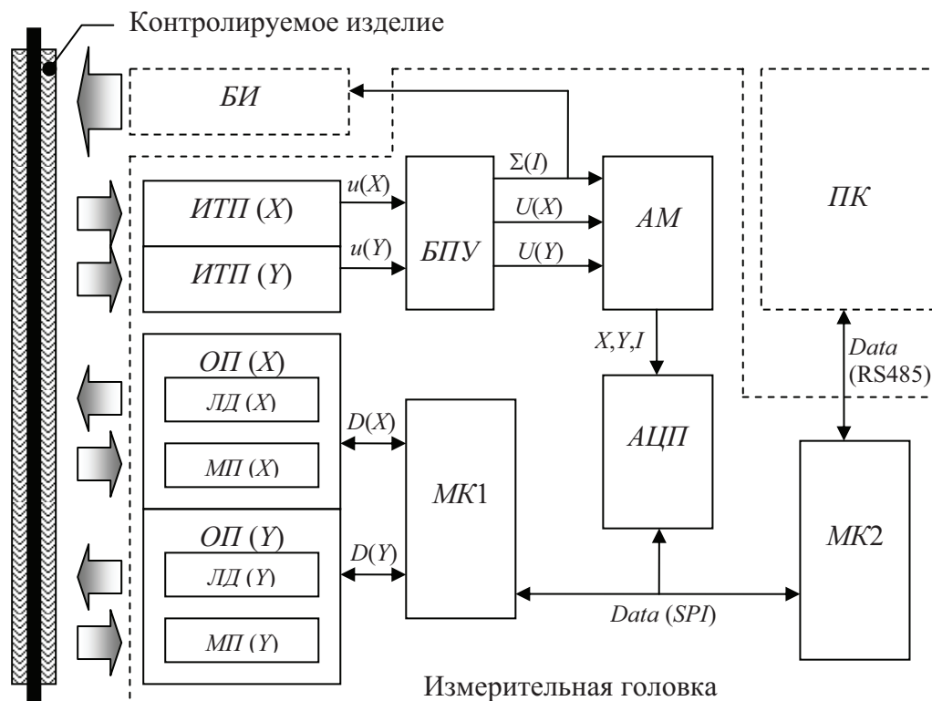
Рис. 4. Функциональная схема измерителя эксцентриситета и диаметра электрического кабеля
